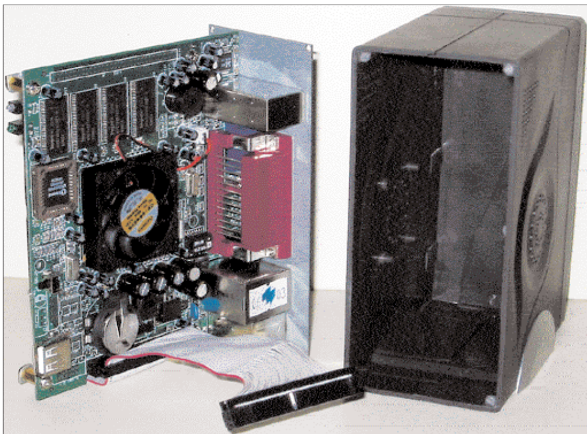
Pieni on kaunista - EBOX on varsin siististi pakattu kokonaisuus. Kiintolevy on emolevyn alapuolella ja IDE-kaapelissa vapaa- na yksi liitin. 128 MB:n perusmuisti riittää jo Windows XP:n pyörittämiseen Linuxista puhumattakaan.
